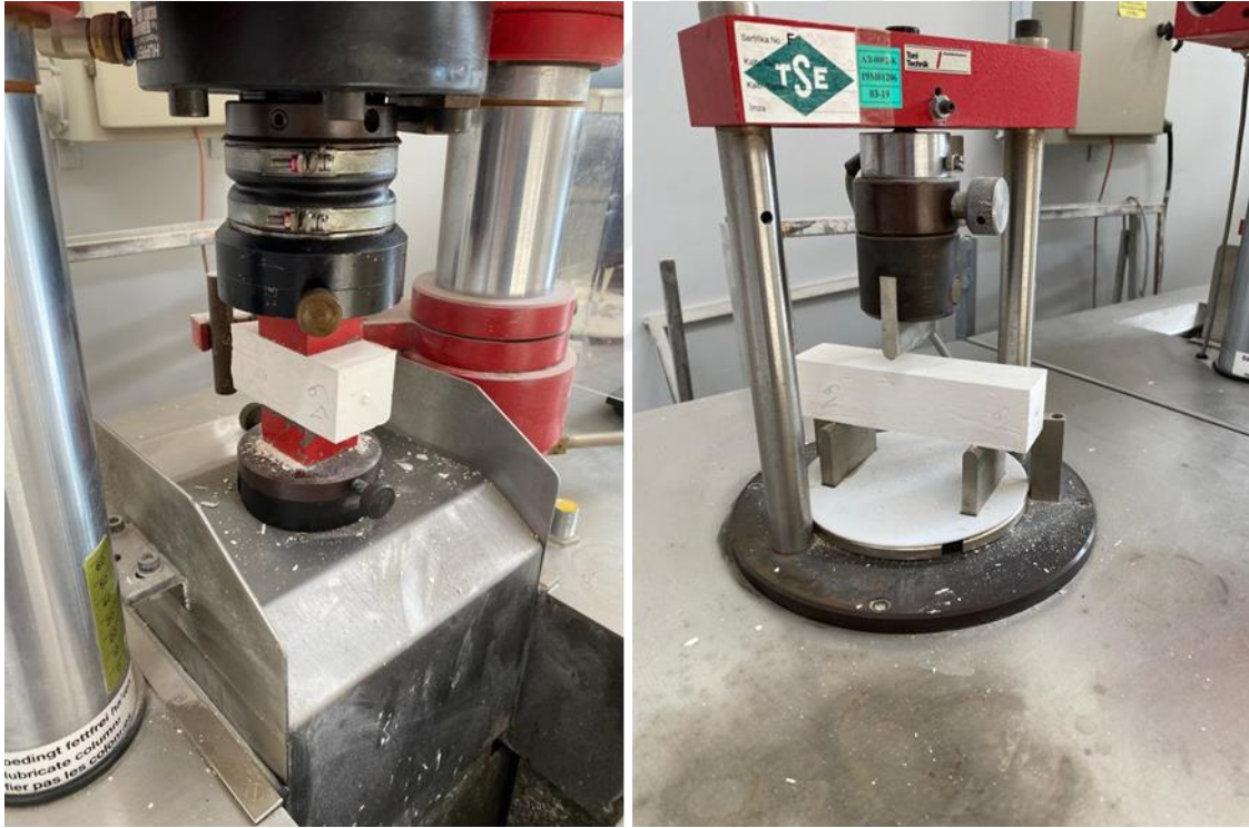
Şekil 4.2. Alçı levhaya uygulanan mekanik (eğilme ve basınç) testler
