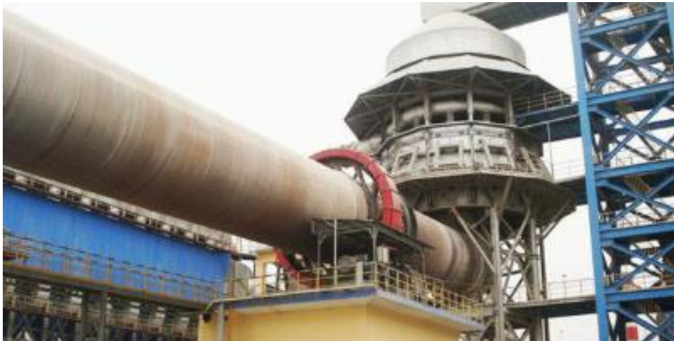
Şekil 3.3. Döner fırında beta alçısı üretimi [48].
