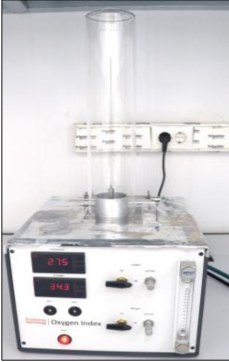
Resim 5.5. Fire testing technology oksijen indeksi test cihazı
