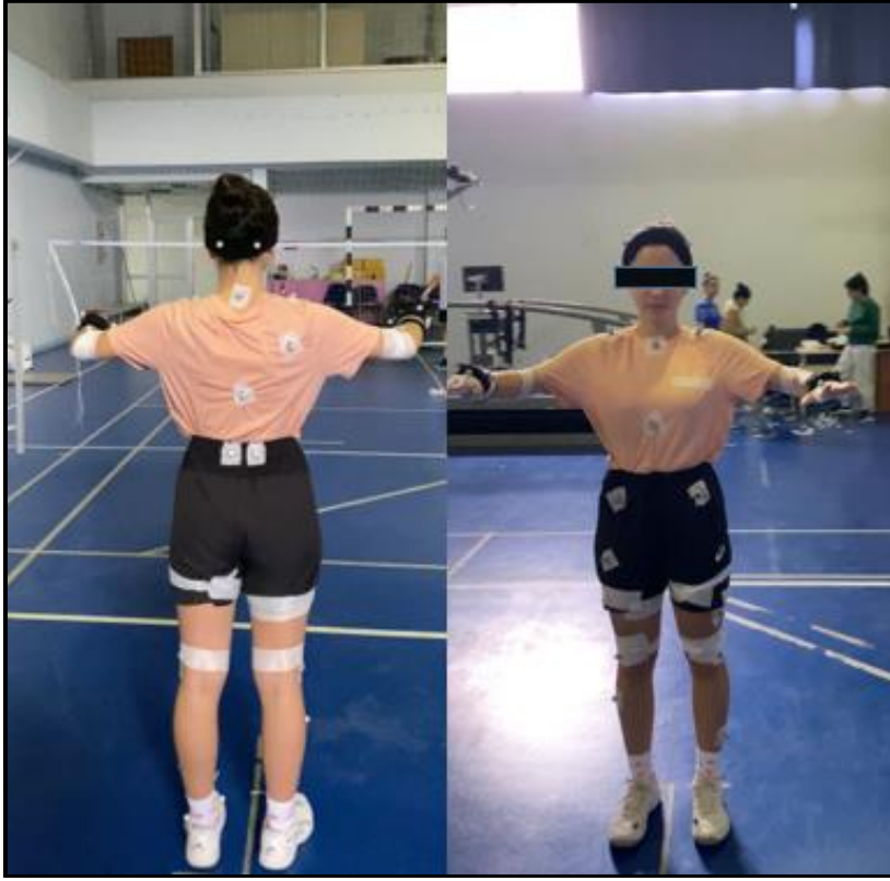
Resim 3.13. Vicon Plug-in Gait Fullbody static modelleme sırasında sporcunun “T poz” konumlanması
