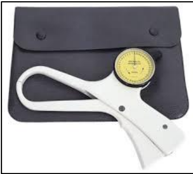
Resim 3.5. Katılımcıların el kalınlığını ölçmek için kullanılan skinfold kaliper (Holtain, UK)
