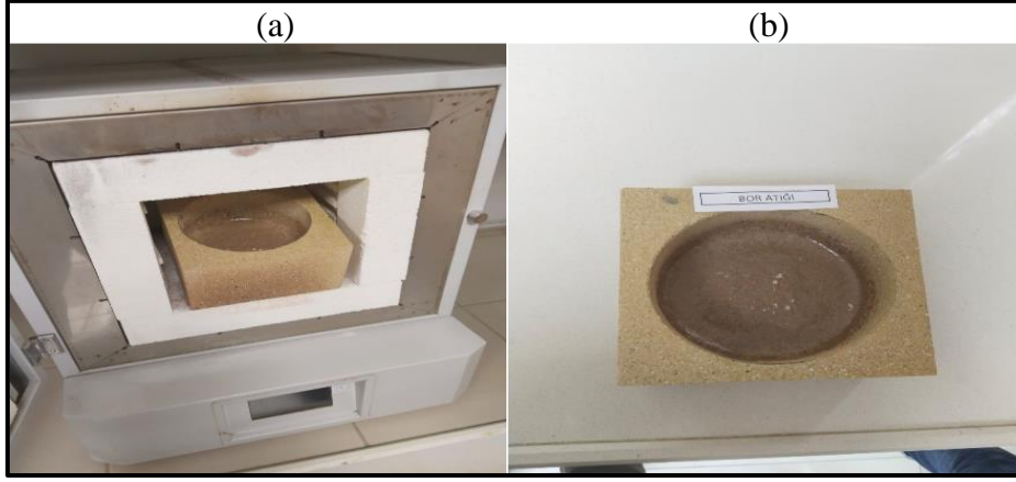
Resim 4.7. (a), (b) Atık numunesinin cam faza geçmesi
