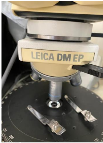
Resim 3.1. Kullanılan polarize ataçmanlı mikroskop
