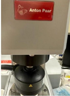
Resim 3.2. Viskoelastisite tayini için kullanılan reometre
