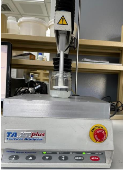
Resim 3.3. TPA analizi için kullanılan cihaz
