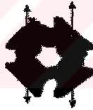
Şekil 2.18. Sinterleme boyunlarına uygulanan yük dağılımı (58)
