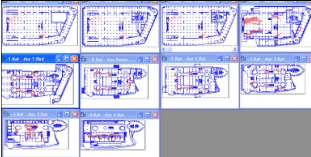
Şekil 5.100. Birinci dakikanın sonunda binada 11094 kullanıcı bulunmaktadır. Binadan 1035 kullanıcı ayrılmıştır.
