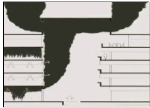
Şekil 2.33. Kapalı atriumlarda duman tahliyesi (6)
