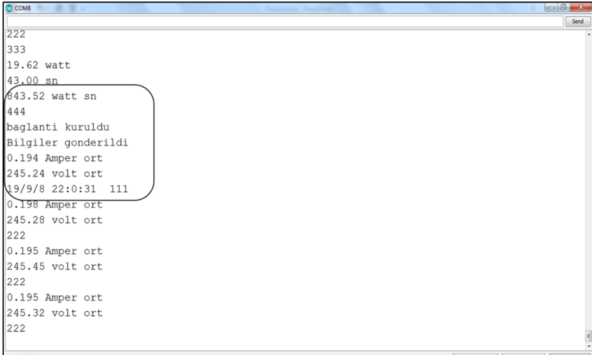
Resim 3.4. Sisteme bağlı olan bir cihazın bağlantısı kesildiği an
