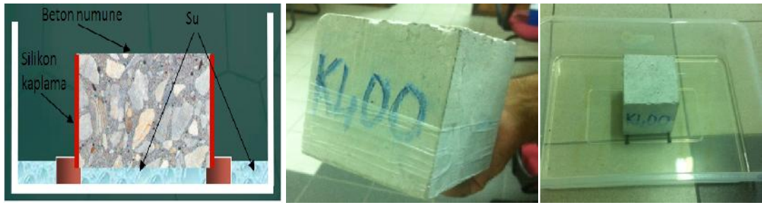
Resim 3.14. Kılcal su emme deneyi uygulaması
