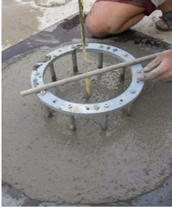
Resim 3.6. J-ringi deneyinin uygulanişı
