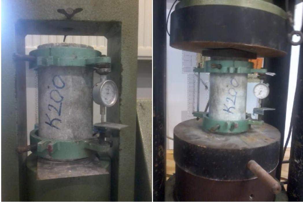
Resim 3.13. Statik elastisite deneyi uygulaması
