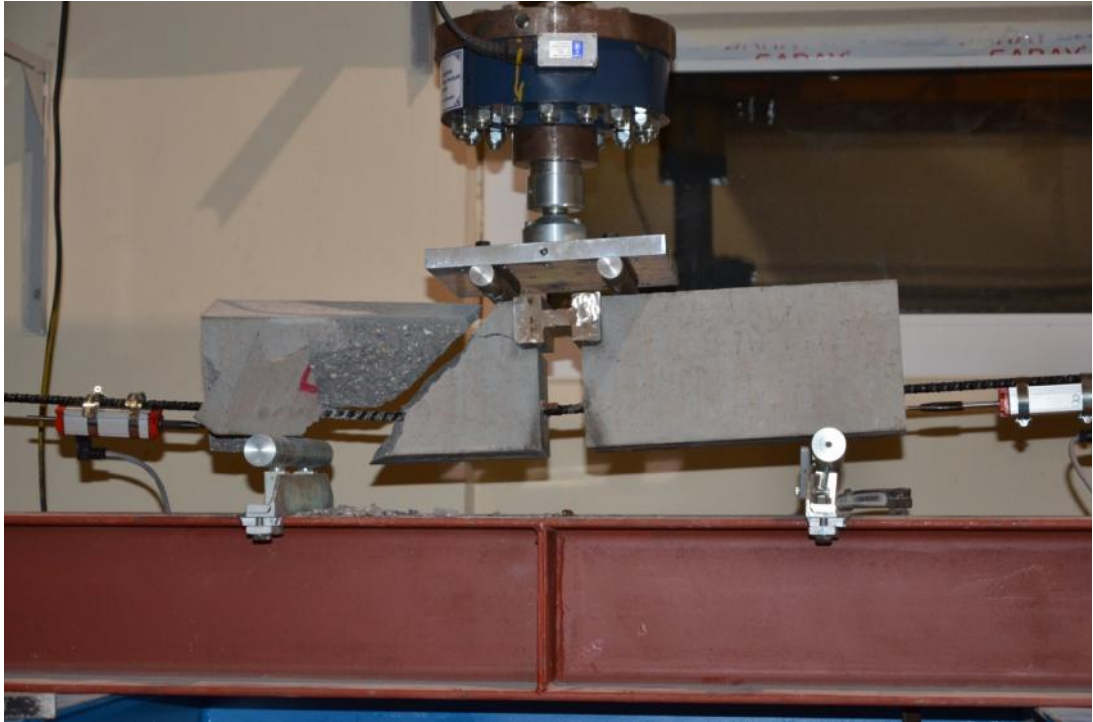
Resim 4.5. Kesme çatlağı oluşan K401 kodlu KYB kiriş numunesi
