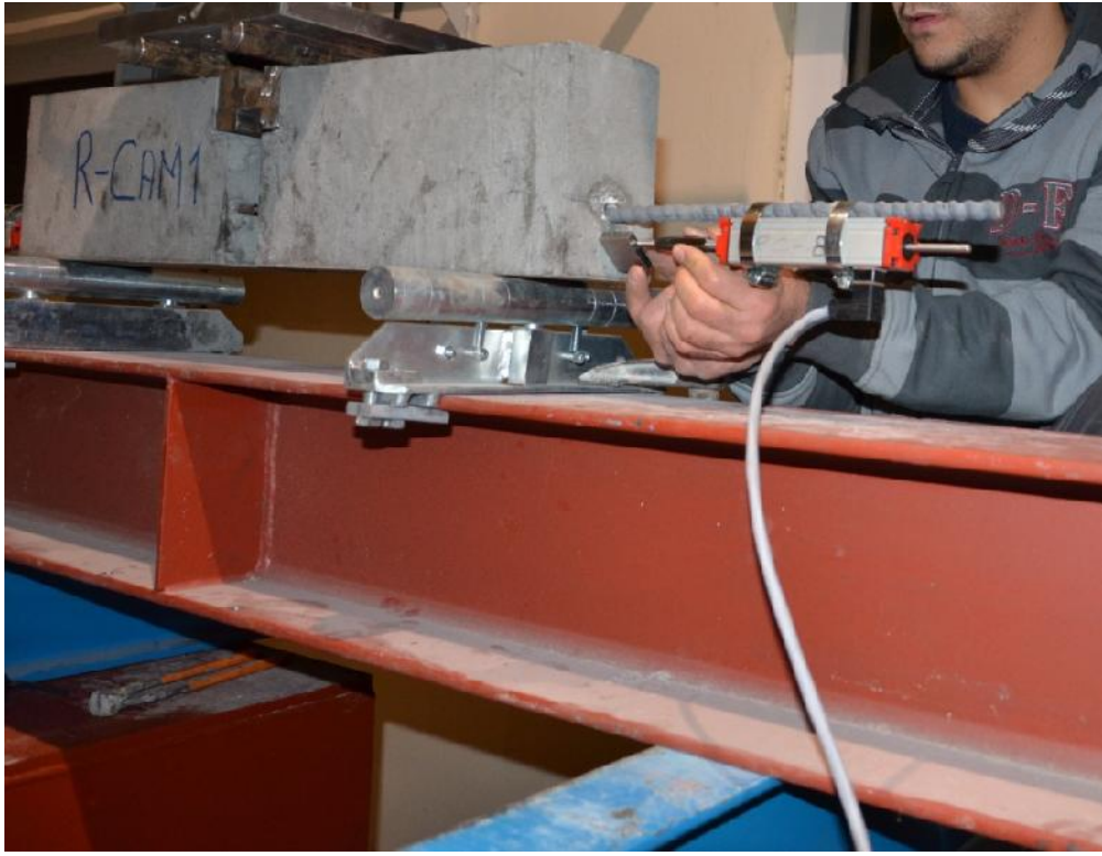
Resim 3.19. Potansiyometrik cetvellerin kalibrasyonu
