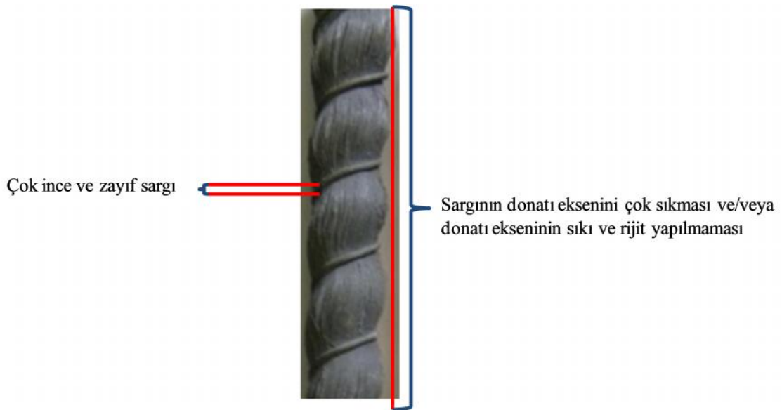
Resim 4.10. Cam lifli donatının yüzey özellikleri
