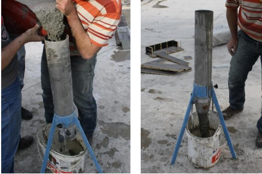
Resim 3.7. Orimet tüpü deneyinin uygulanışı
