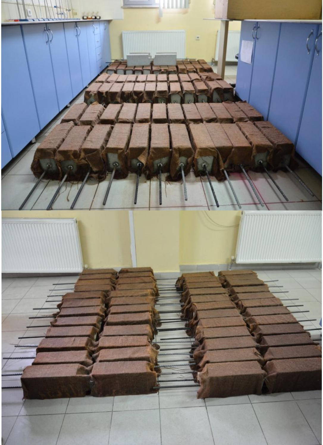
Resim 3.18. Üretilen ve kür uygulanan tüm kiriş numuneleri
