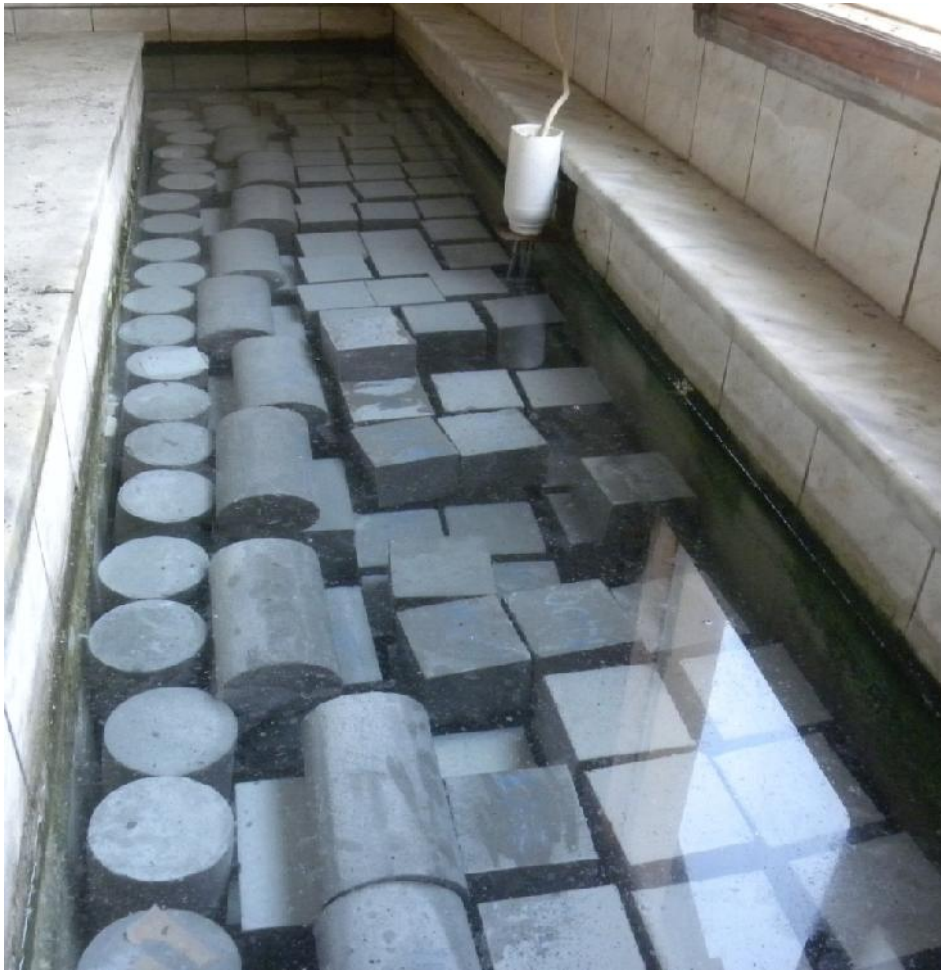
Resim 3.9. Kür havuzunda bekletilen KYB numuneleri
