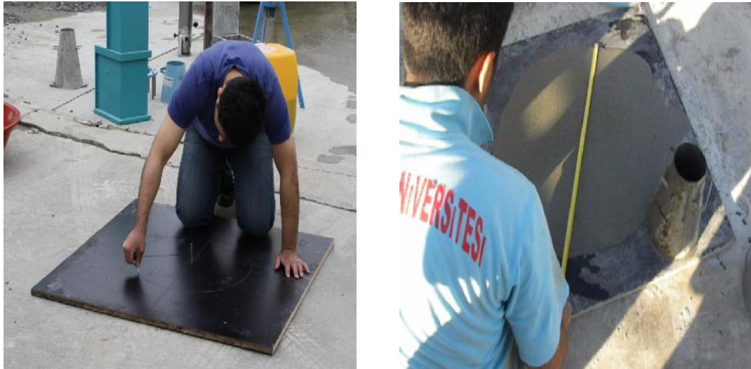
Resim 3.2. Çökme yayılma tablası hazırlanması ve deneyin uygulanışı
