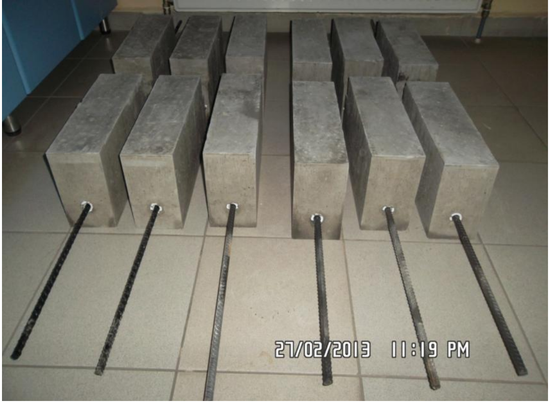
Resim 3.17. Kalıptan çıkarılan kiriş numuneleri
