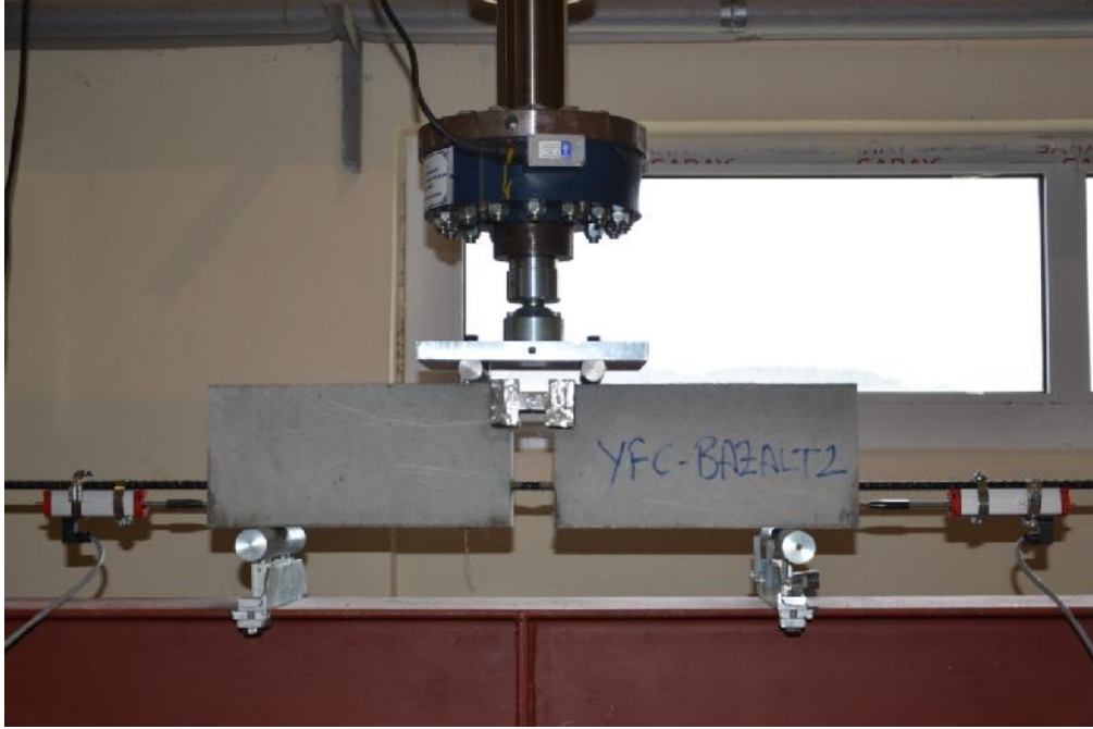
Resim 3.20. BMK deneyinin uygulanaşı
