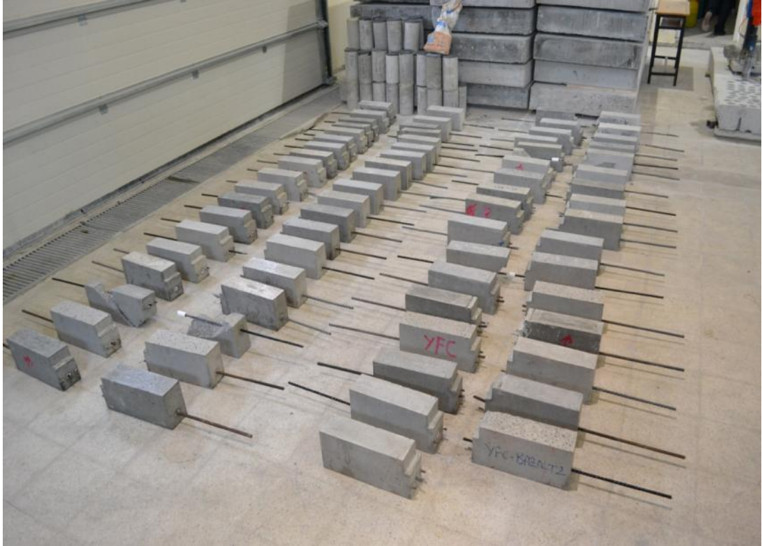
Resim 4.4. Eğilmede aderans deneyi yapılan bazı BMK numuneleri
