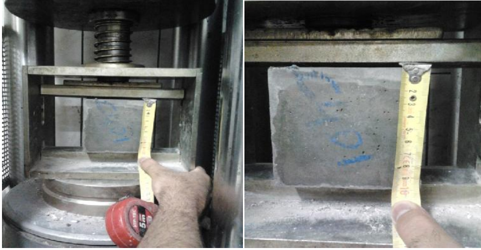
Resim 3.12. Yarmada çekme deneyinin uygulanması
