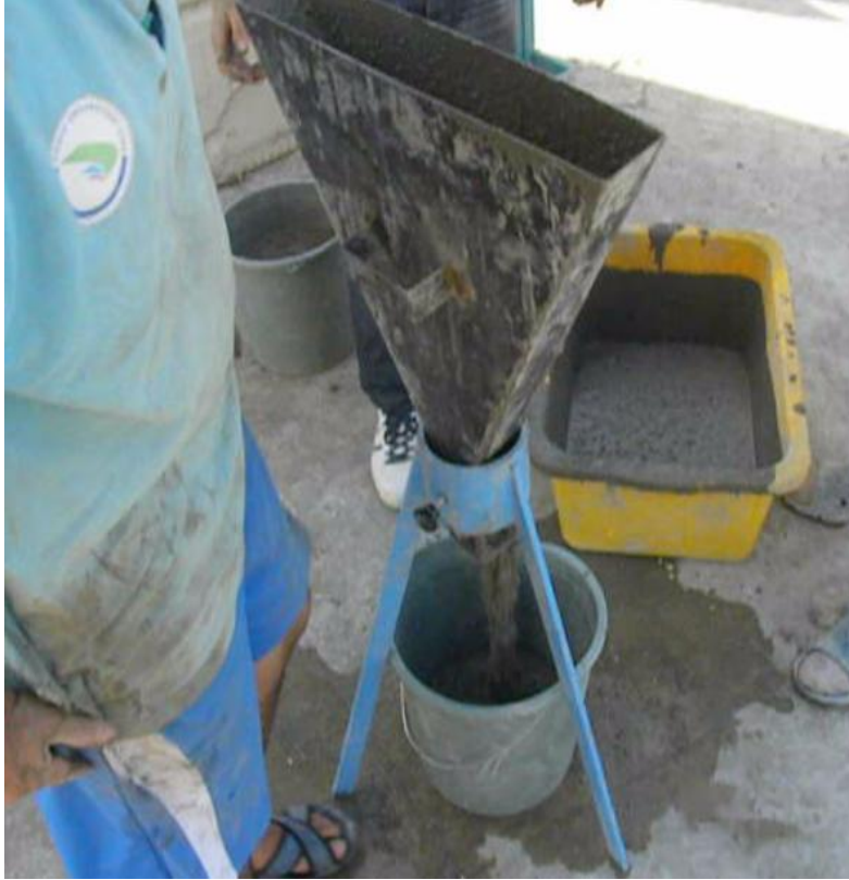
Resim 3.3. V-Hunisi deneyinin uygulaması
