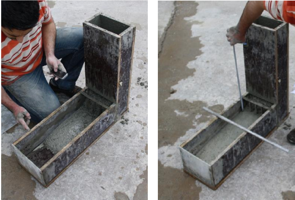
Resim 3.4. L-kutusu deneyinin uygulanışı
