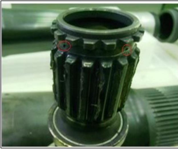
Resim 3.6. Helikopterden sökülen torkmetre şaftın kaplaması yıpranmış dişli bölümü
