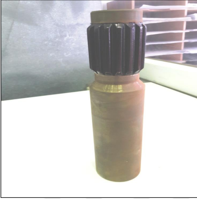
Resim 4.1. İmal edilen şaftın kaplama görüntüsü
