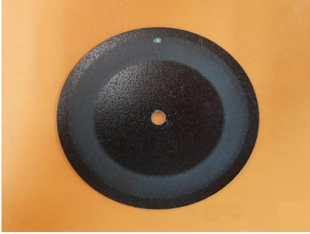
Resim 4.8. Aşındırma testi sonrası poliamid-11 kaplı DKP plakanın yüzey görüntüsü
