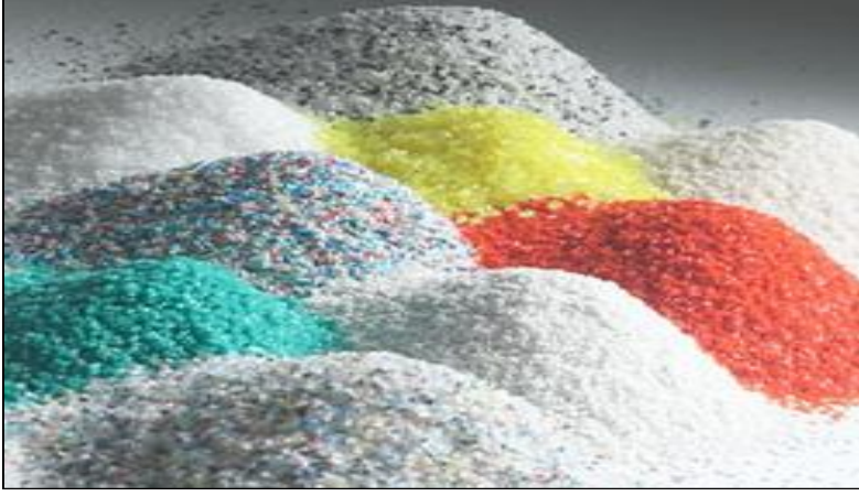
Resim 2.2. Kumlama makinesinde kullanılan plastik medya ve cam tozu [20]
