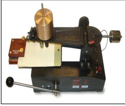
Resim 3.13. Manuel tip çizik cihazı [49]
