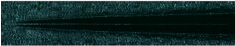
Şekil 4.23. 25 N'a kadar yapılan çizik testinin optik mikroskop görüntüsü
