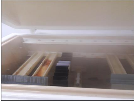
Resim 3.11. Tuz püskürtme testi kabin içi görüntüsü
