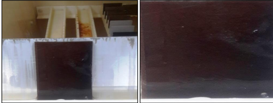
Resim 4.2. 200 \mu\text{m} kalınlıkta poliamid-11 kaplı Al-2024 plakanın 336 saat tuz testi sonrası görüntüsü
