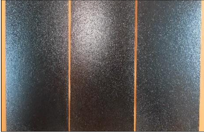
Resim 4.3. Poliamid-11 kaplı St-37çelik plakaların 720 saat tuz testi sonrası görüntüsü
