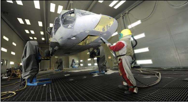
Resim 2.3. Hava aracı gövdesine uygulanan kumlama işlemi [21]
