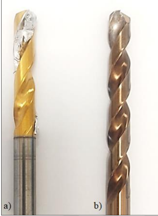
Şekil 5.3. Aynı kesme parametrelerinde Karbür ve HSS takımlarda BUE oluşumu a) Karbür takım b) HSS takım
