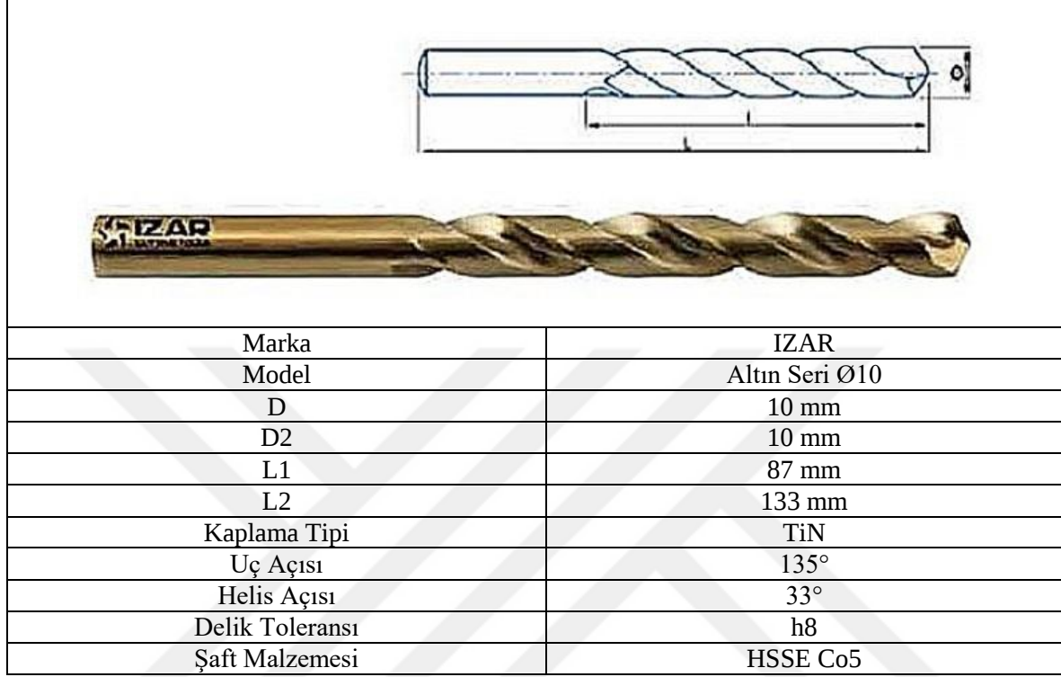
Şekil 4.1. HSS matkap ucu teknik resmi ve özellikleri
