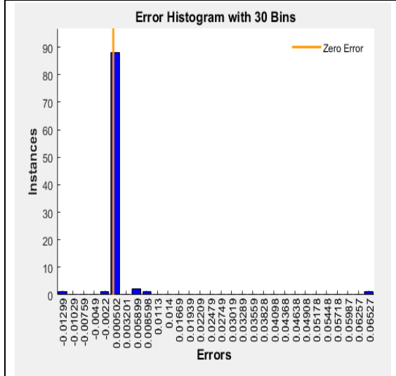
Şekil 6.12. Model A yapay sinir ağı modelinin 30 bins error histogramı
