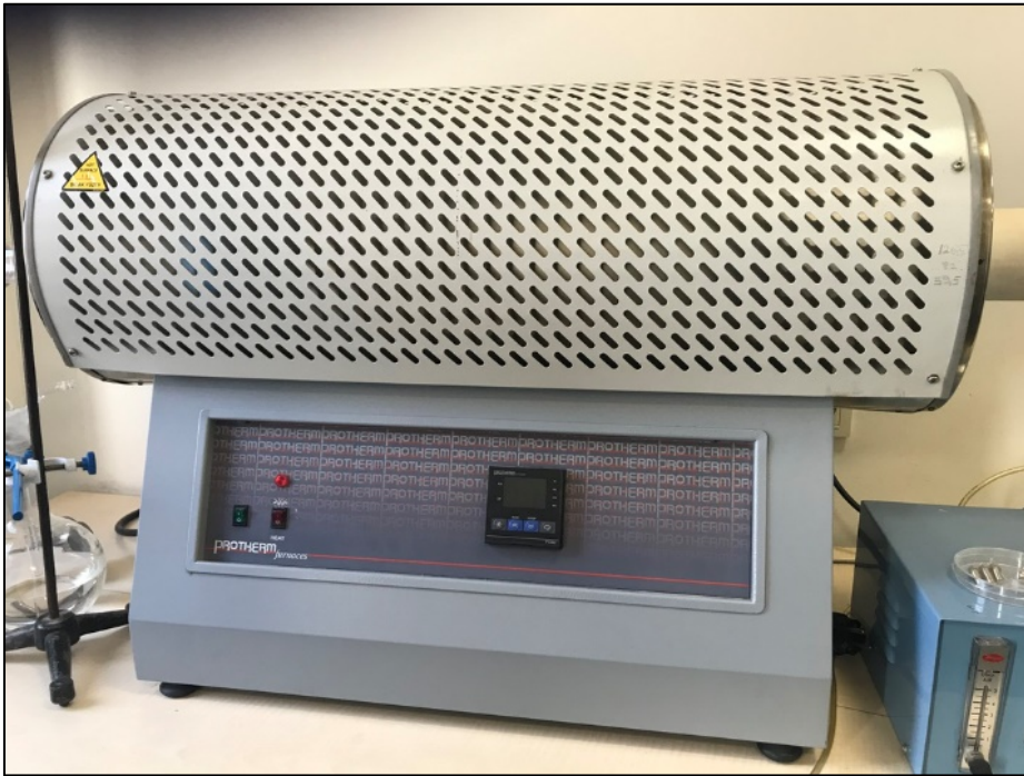
Resim 3.4. Numunelerin tavllanması için kullanılan tüp fırına ait görüntü
