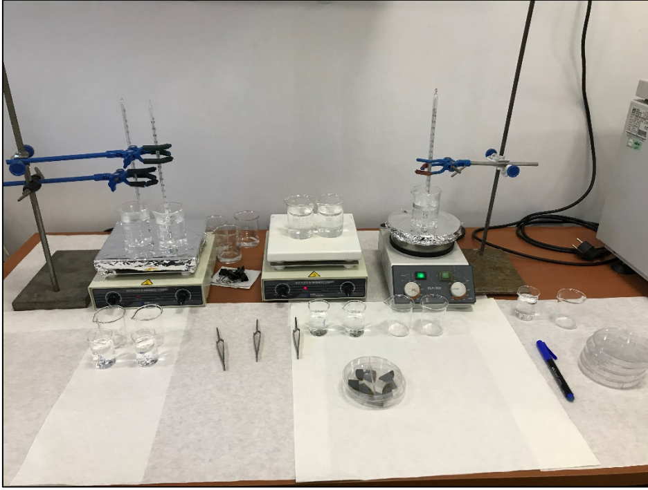
Resim 3.3. SILAR büyüme işlemi deney düzeneği
