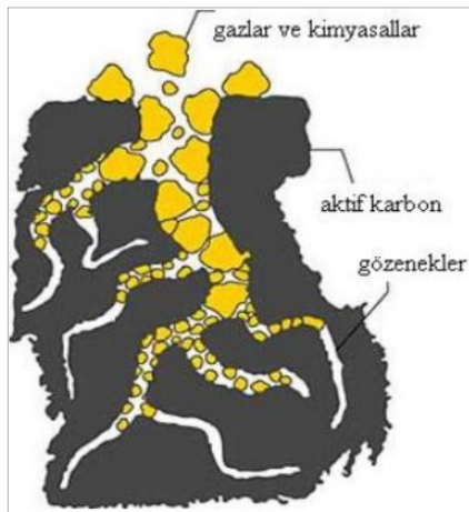
Resim 3.1. Gaz moleküllerinin ve kimyasalların aktif karbon yüzeyine adsorpsiyonu [40].
