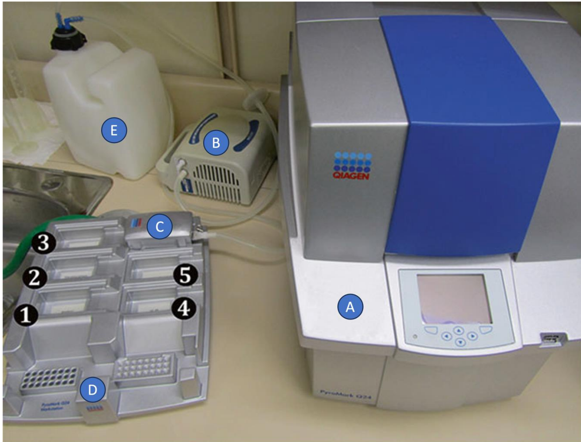
Resim 3.1. Pyromark Q24 çalışma istasyonu. A: Sekans ünitesi, B: Vakum motoru, C: El probu, D: Yıkama ünitesi, E: Atık ünitesi [67]
