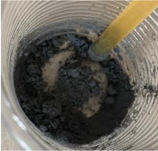
Resim 5.2. Örnek nüvelerde kullanılan manyetik tanelerin yapısı
