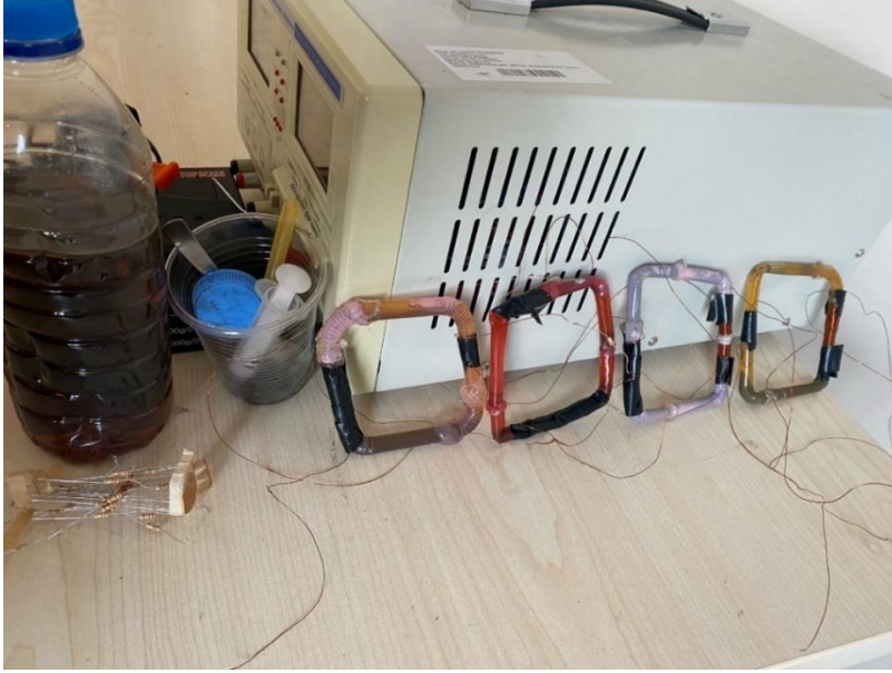
Resim 5.1. Farklı manyetik tane kütle farkasiyonuna sahip akışkan nüveli transformatör örnekleri
