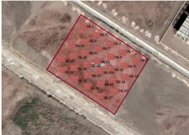
Resim 4.3. Arazi sondaj çalışmalarının lokasyonları (Zemin ve temel etüdü veri raporu, Star Jeoteknik, Nisan 2021, Ankara)
