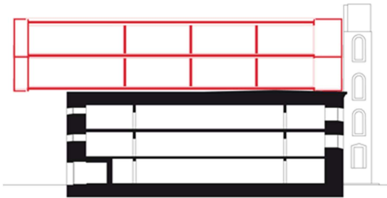
Resim 4.6. Kulturbunker kesiti (URL-26)
