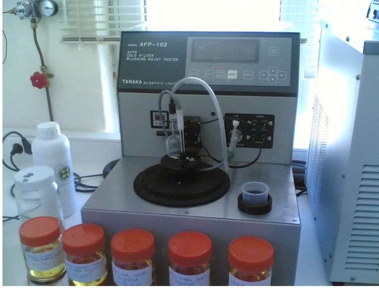
Resim 4.6. Soğuk filtre tıkanma noktası deney cihazı
