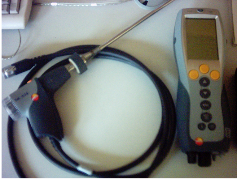
Resim 4.10. Testo 335 marka baca gazı ölçüm cihazı
