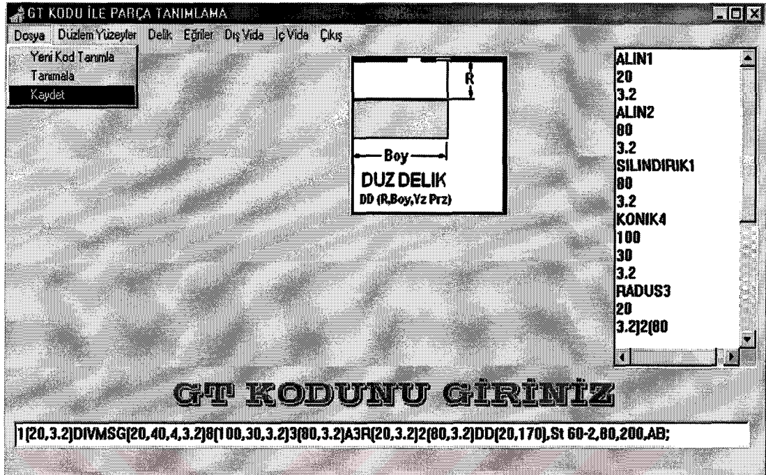
Şekil 8.38. Örnek parça unsur kodları ve unsur tanımları
