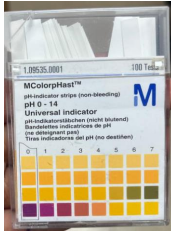
Şekil 8. pH indikatör stripleri ve pH renk skalası.
