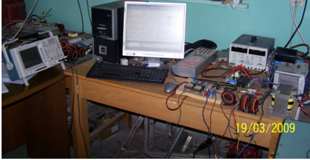
Resim 5.4. Bir fazlı şebeke etkileşimli evirici deney düzeneği
