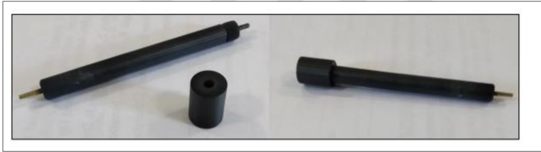
Şekil 3.2. Teflondan yapılmış karbon pasta elektrot
