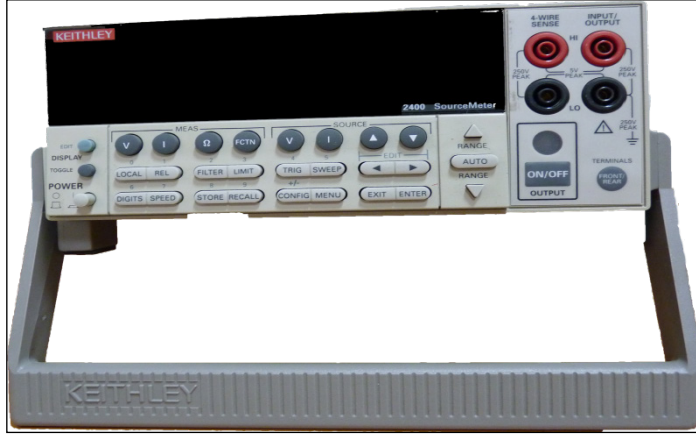
Resim 3.1. Keithley 2400 akım-gerilim kaynağı
